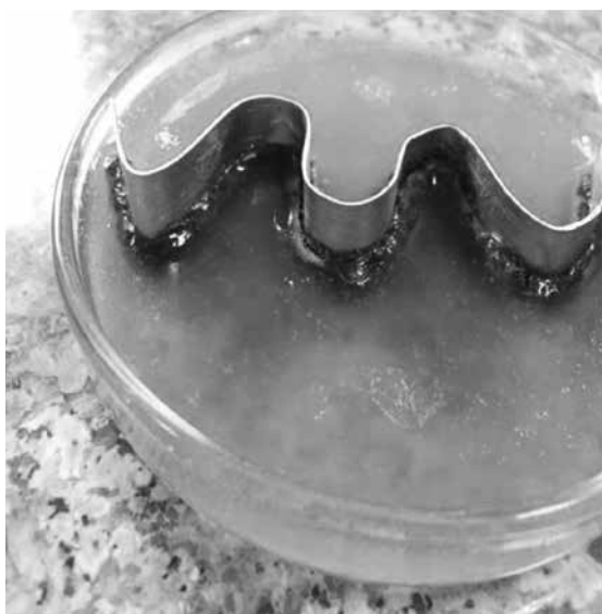
▲ شکل ۱ پتری حاوی ورقه آلومینیم و رسوب مس
